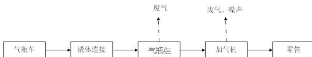
图 2-3 加气站工艺流程及产污节点图
